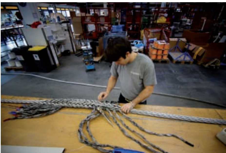
Handarbeit: Jan Kneipp und fertigt ein Seil, mit dem man 350-Tonnen-Gondeln von Windkraftanlagen hochheben kann.
